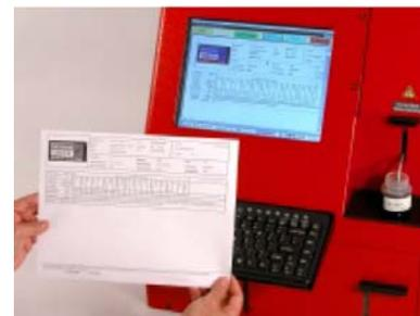
безаварийной работы. Через 5 минут Вы получите концентрации металлов и указания на проблемные узлы двигателя.
